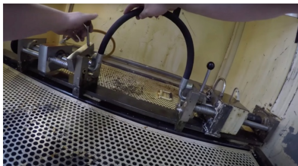
Bild 15. Slangmontage med två 90 graders stålanslutningar.
