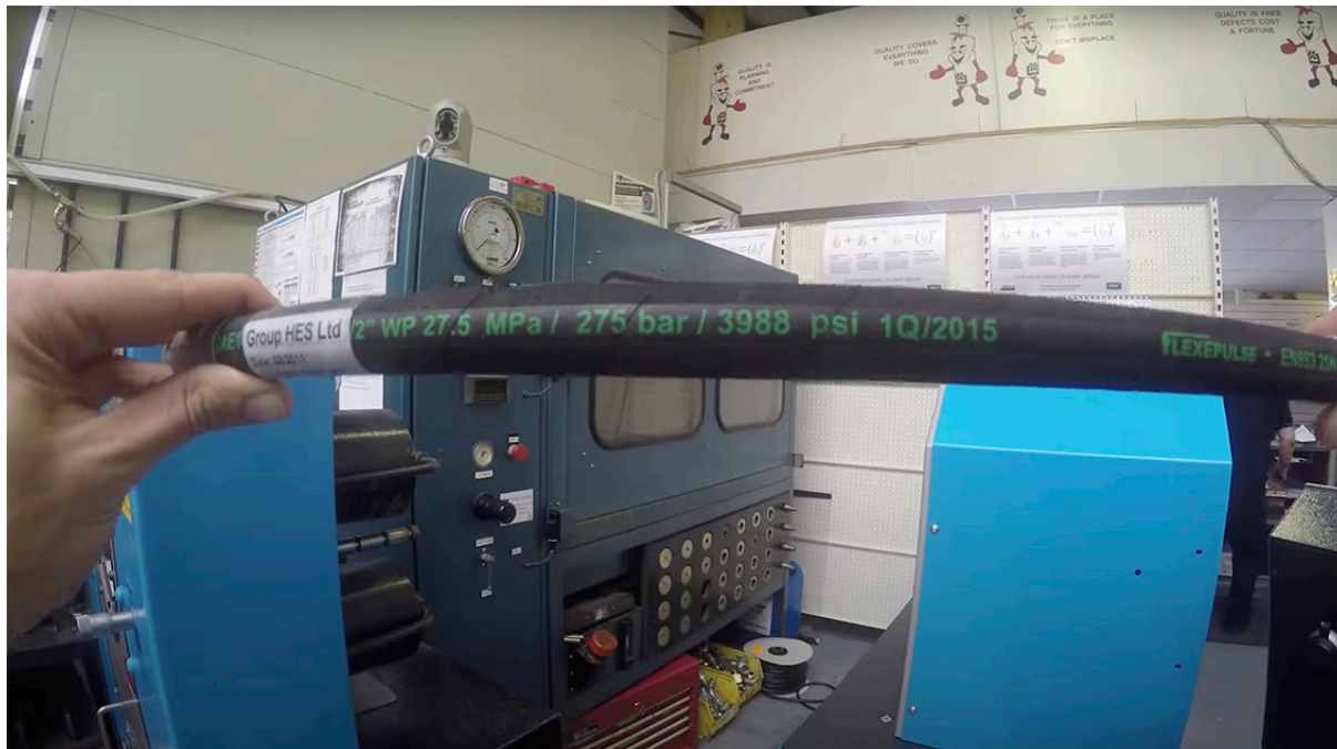
Bild 14. Hydraulslangens märktryck, 275 bar.
