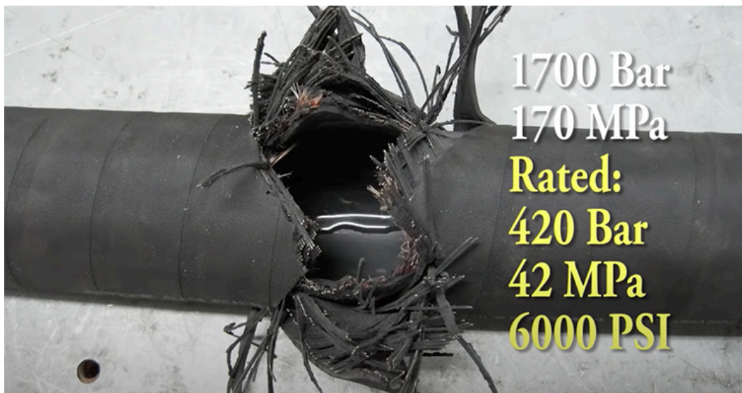
Bild 13. Skada, totalt brott. Om slangens hade blivit sönderdragen hade skadan varit liknande.
