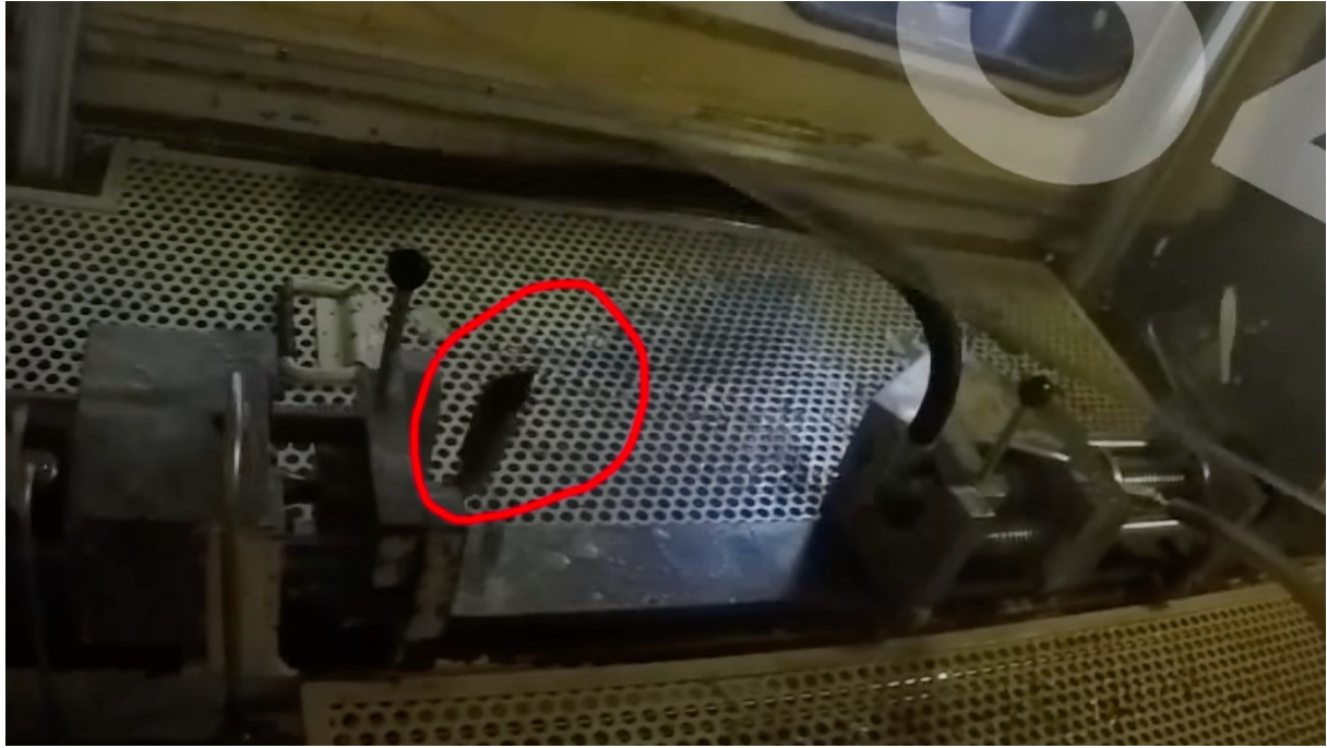
Bild 19. Kvarvarande slangrester efter att hydraulslangen brustit.
