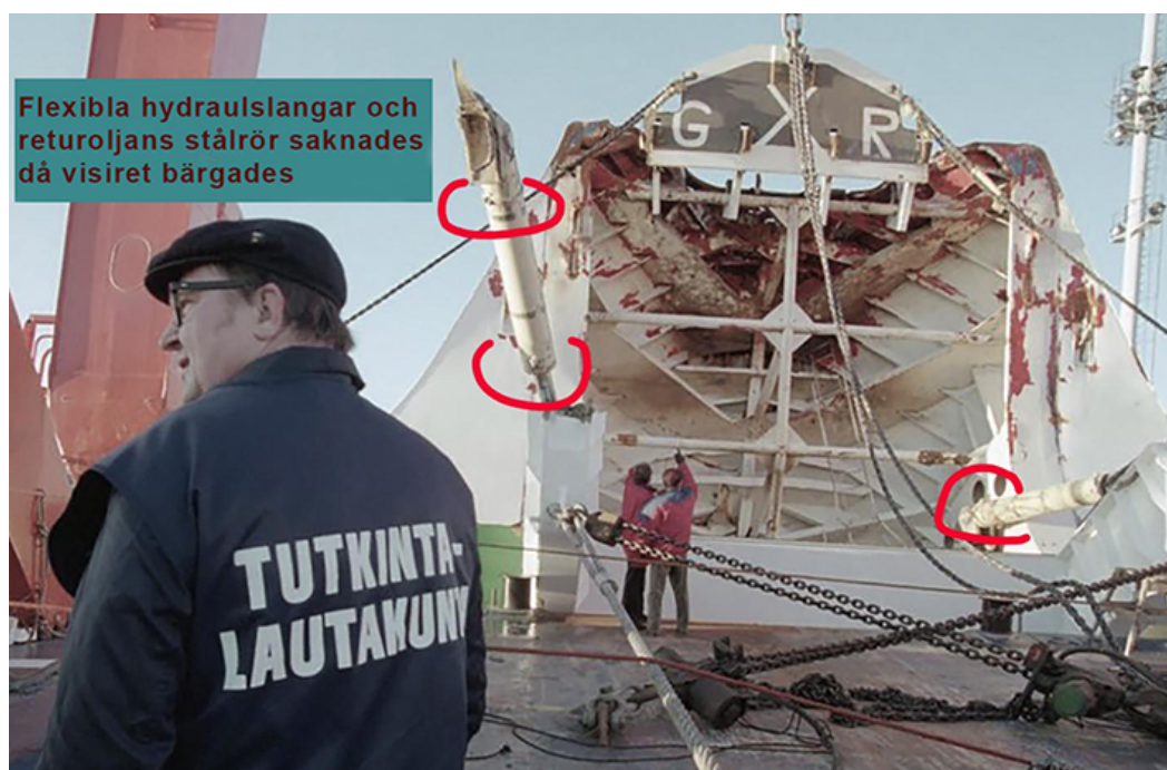
Bild 7. De saknade slangarna och rören skulle varit placerade inom den röda markeringen. Bild 7 och 8 togs när visiret hade bärgats och gjorts fast på MVS Nordica.
