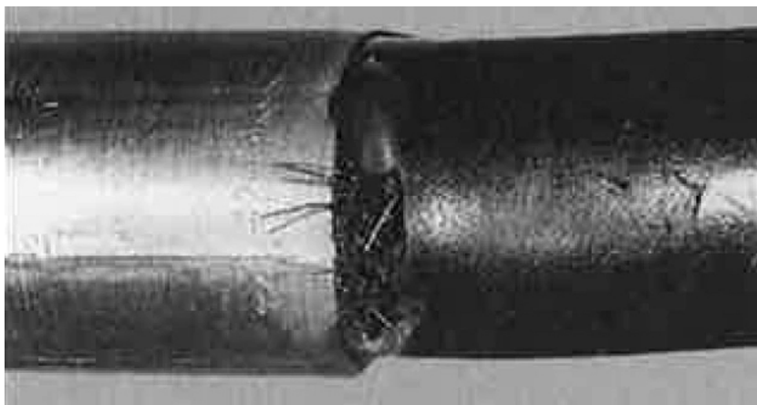
Bild 20. Exempel på brusten hydraulslang på grund av överdriven dragkraft.
